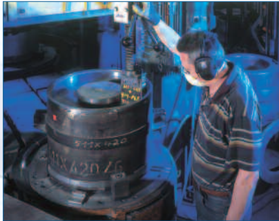
Prasowanie ściernic zgodnie z dokumentami produkcji
